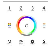
**ES:** Toque la tecla de encendido para encender la luz, apague la luz, luego, inmediatamente, pulse prolongadamente la tecla de encendido durante 5 segundos, para entrar en la configuración de la luz de la zona: Pulse prolongadamente la tecla de zona 1/2/3/4 durante 2 segundos, seleccione la zona actual que deseé cambiar, luego presione prolongadamente la tecla inferior a cinco segundos para cambiar el tipo de luz de la zona actual.
